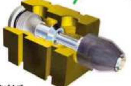
チェックバルブ 各シリンダーの動きを制御します。外側に取り付けられるため簡単にアクセスできます。
